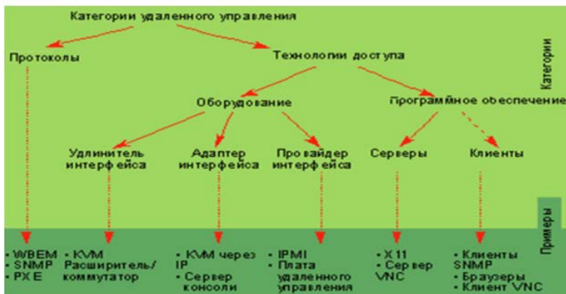
Рис. 1. Схема таксономии универсального интерфейса для управления удалёнными приборами
