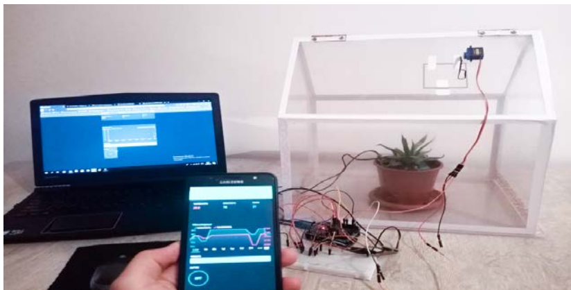
Сурет 1. Топырақтың ылғалдылығын анықтайтын SMART басқару жүйесінің тіжірибелік көрінісі
