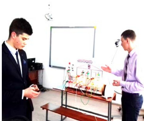
Рис. 1 Разработанный лабораторный стенд «Умный дом» на базе WiFi -реле Sonoff
