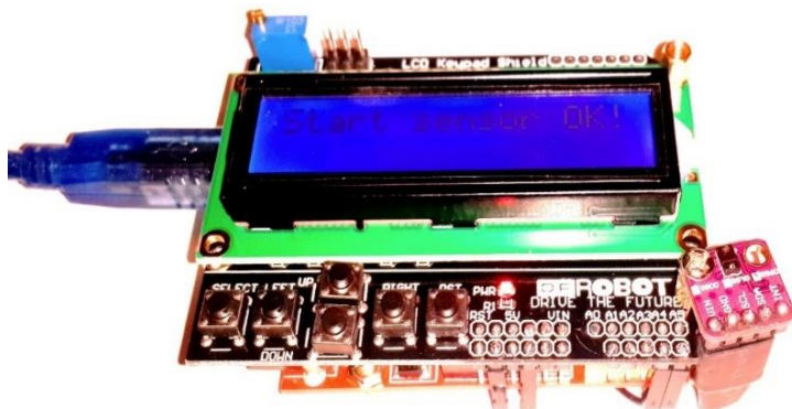
Рисунок 1. Разработанная модель устройства с датчиком жестов.
