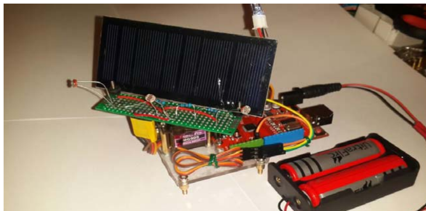
Рисунок 1. Солнечная батарея с тремя датчиками света (солнечные датчики) на плате Arduino
